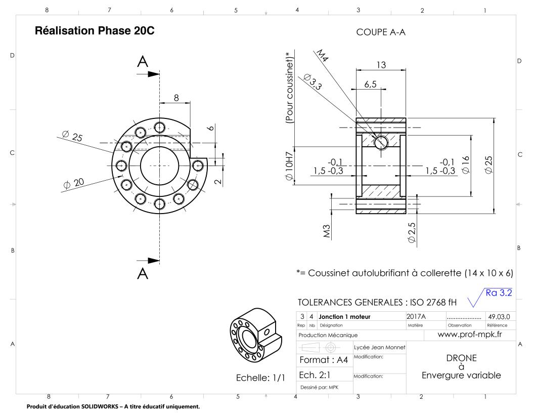
Système: Drone envergure réglable Pièce : Jonction\_1\_moteur Matière : 2017A
